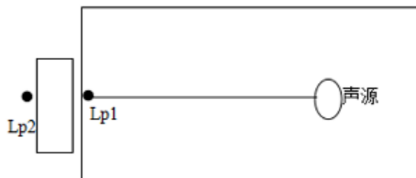
图 4-1 室内声源等效为室外声源图例
